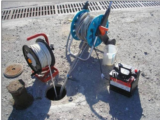
Photo 27 : Matériel de prélèvement des eaux souterraines
